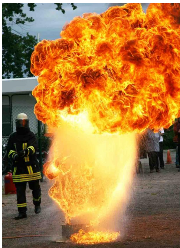
Abb. 1 Die FFW Strausberg zeigt, was passiert, wenn Fettbrände mit Wasser gelöscht werden
